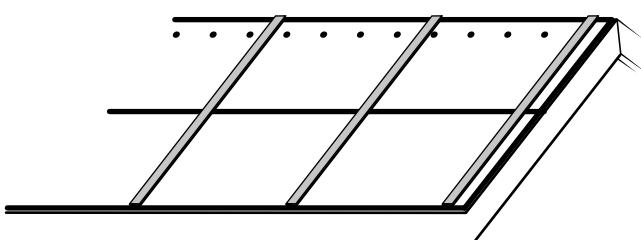
**Область применения:** Применяется в коттеджном и малоэтажном строительстве в качестве гидроизоляционного подкладочного ковра в конструкциях скатных кровель под битумную гибкую (мягкую) черепицу.
